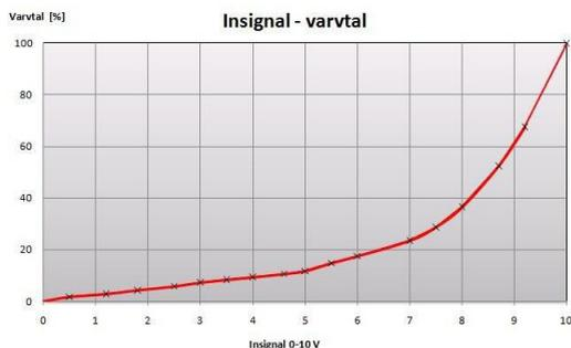
Innsignalet er direkte proporsjonalt med rotorens effektivitet, noe som betyr at innsignalet og omdreiningstallet er i henhold til det tilsvarende diagrammet.
